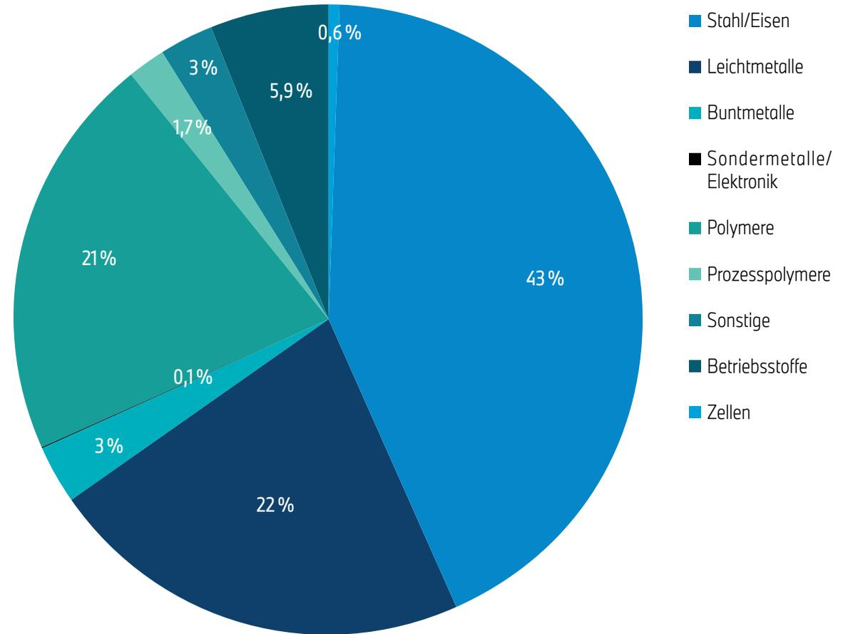
Abb. 2: Werkstoffzusammensetzung der BMW 520i Limousine zum Produktionsstart
