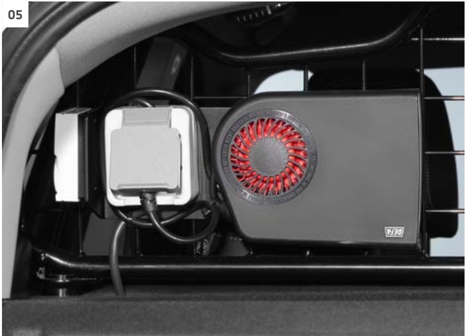
[ 04/ 06 ] Integrierter Waffenkasten in der Beifahrertür: mit einer Abdeckung (l.) für maximale Diskretion. [ 05 ] Im Gepäckraum mit Versorgung eines angeschlossenen Heizlüfters inkl. Thermostat.
