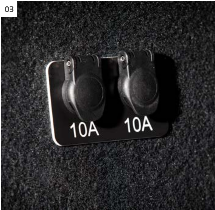
[ 01 ] Integrierte Bedienteilehalterung für Signalanlage und Funk. [ 02 ] Digitalfunkantenne Procom 640mm, Strahler vor Finne F48. [ 03 ] 2 x 12-Volt-Steckdosen nach DIN 4165 im Gepäckraum.
