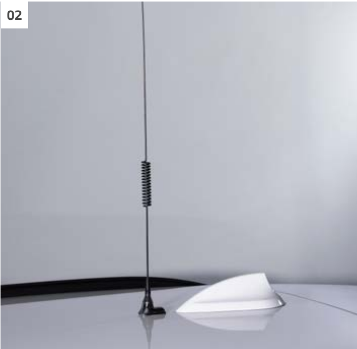
[ 01 ] Integrierte Bedienteilehalterung für Signalanlage und Funk. [ 02 ] Digitalfunkantenne Procom 640mm, Strahler vor Finne F48. [ 03 ] 2 x 12-Volt-Steckdosen nach DIN 4165 im Gepäckraum.
