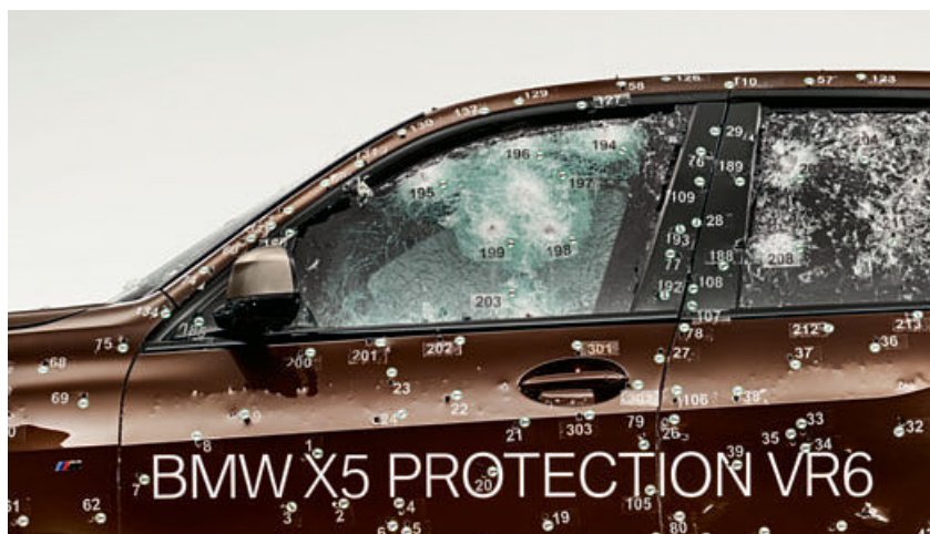
Mehrlagen-Sicherheitsglas: Fahrer und Passagiere des neuen BMW X5 Protection VR6 werden durch ein etwa 30 mm starkes Mehrlagen-Sicherheitsglas mit innen liegender Polycarbonat-Splitterschutzschicht geschützt.
