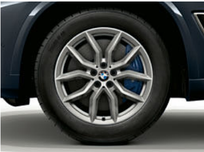
■ 19" Leichtmetallräder V-Speiche 734 Reflexsilber mit Notlaufeigenschaften, Radgröße 9J x 19, Bereifung 265/50 R19.
