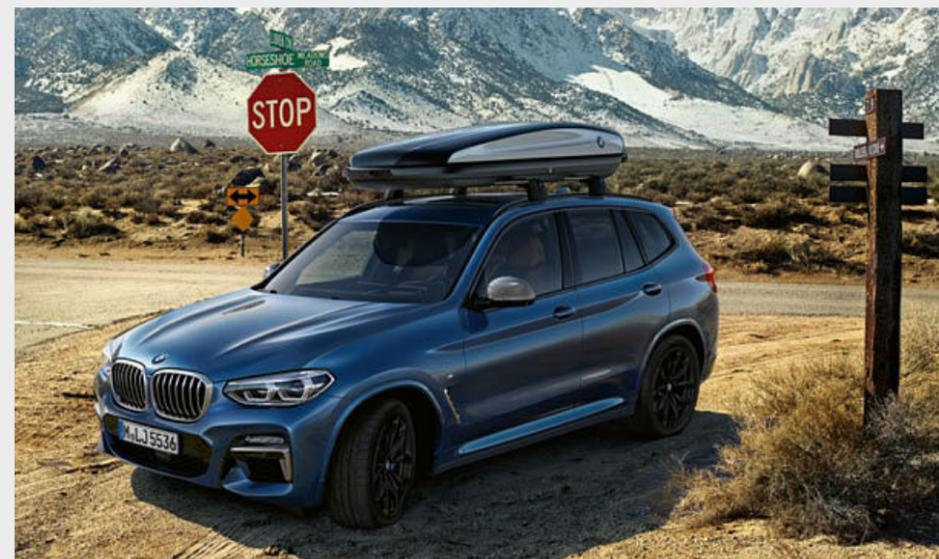
○ Die moderne **Dachbox** in Schwarz mit titansilbernen Seitenblenden hat ein Fassungsvermögen von 520 Litern und passt zu allen BMW Dachträgersystemen. Durch ihr beidseitiges Öffnungssystem mit 3fach-Zentralverriegelung auf beiden Seiten ist sie einfach zu beladen und diebstahlhemmend abschließbar.
