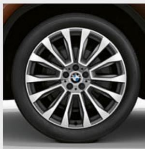
□ 20" Leichtmetallräder Y-Speiche 697 Bicolor Ferricgrau glanzgedreht, mit Mischbereifung und Notlaufeigenschaften, Radgröße vorn 8J x 20, Bereifung 245/45 R20, Radgröße hinten 9,5J x 20, Bereifung 275/40 R20.
