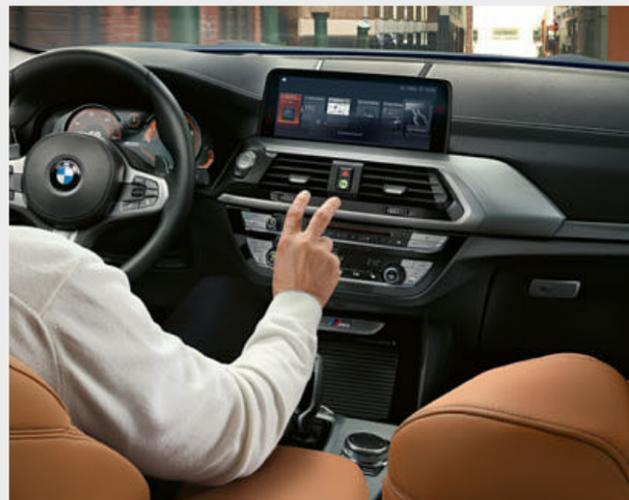
□ Mit der BMW Gestiksteuerung<sup>2</sup> lassen sich festgelegte Funktionen durch bestimmte Handbewegungen bedienen. Für bestimmte Bedienvorgänge erkennt das System z. B. die Gesten „Wischen“ oder „Zeigen“, mit denen u. a. das Ablehnen und Annehmen eines eingehenden Anrufs bedient werden können oder das Regeln der Lautstärke durch Drehbewegungen mit dem Zeigefinger.
