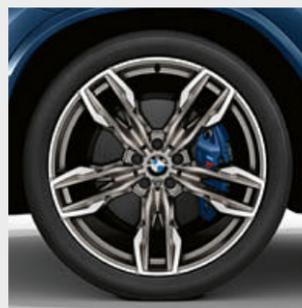
□ 21" M Leichtmetallräder Doppelspeiche 718 M Bicolor Ceriumgrau matt glanzgedreht<sup>2</sup>, mit Mischbereifung und Notlaufeigenschaften, Radgröße vorn 8,5J x 21, Bereifung 245/40 R21, Radgröße hinten 9,5J x 21, Bereifung 275/35 R21.
