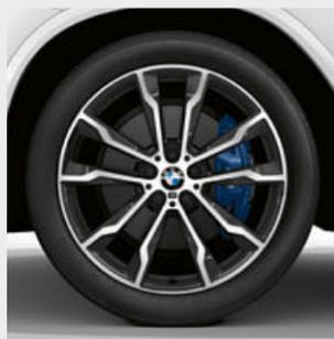
□ 20" M Leichtmetallräder Doppelspeiche 699 M Bicolor Orbitgrau glanzgedreht<sup>1</sup>, mit Mischbereifung und Notlaufeigenschaften, Radgröße vorn 8J x 20, Bereifung 245/45 R20, Radgröße hinten 9,5J x 20, Bereifung 275/40 R20.
