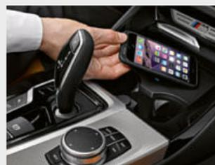
□ Die Telefonie mit Wireless Charging<sup>3</sup> umfasst eine Ladeschale mit drahtloser Ladefunktion und zusätzlichen USB-Anschlüssen. Per Bluetooth lassen sich zwei Mobiltelefone und ein Audio-player zugleich verbinden. Dazu kommen Bluetooth Office sowie eine WLAN Hotspot Vorbereitung.
