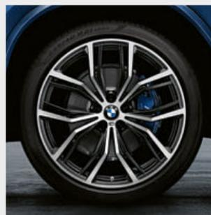
○ 21" BMW M Performance Leichtmetallräder Y-Speiche 701 M Bicolor Schwarz matt, sichtbar glanzgedreht, Sommerkomplettradsatz mit Mischbereifung und Notlaufeigenschaften. Bereifung vorn 245/40 R21, hinten 275/35 R21.
