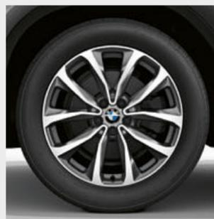
□ 19" Leichtmetallräder V-Speiche 692 Bicolor Ferricgrau glanzgedreht, Radgröße 7,5J x 19, Bereifung 245/50 R19.<sup>3</sup>
