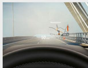
□ Das vollfarbige BMW Head-Up Display<sup>4</sup> blendet per optischer Projektion alle für die Fahrt relevanten Daten in das Sichtfeld des Fahrers ein.
