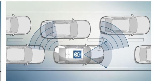
□ Der Driving Assistant Plus enthält den **Spurhalteassistenten mit aktivem Seitenkollisionsschutz**, der den Fahrer durch aktive Lenkeingriffe dabei unterstützt, ein unbeabsichtigtes Verlassen der Fahrspur sowie Kollisionen mit Objekten seitlich des Fahrzeuges zu vermeiden.
