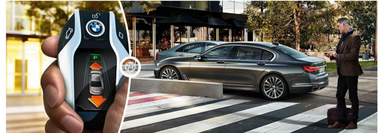
Die optionale Funktion **Ferngesteuertes Parken<sup>1</sup>** erlaubt dem Fahrer, das Fahrzeug bequem zu verlassen und dann das Fahrzeug ferngesteuert vorwärts in eine enge Parklücke oder Garage ein- bzw. rückwärts ausparken. Die ferngesteuerte Einparkfunktion aktiviert der Fahrer außerhalb des Fahrzeuges mithilfe des serienmäßigen BMW Display Schlüssels.
