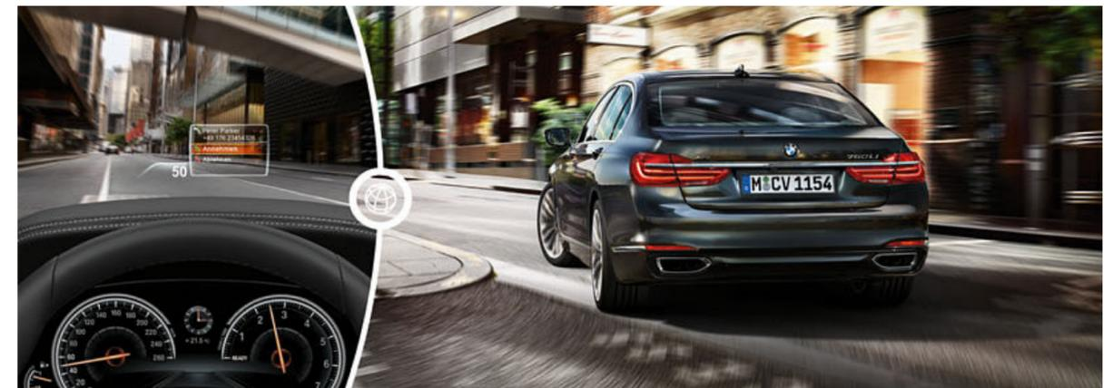
Das optionale vollfarbige **BMW Head-Up Display<sup>2</sup>** blendet per optischer Projektion alle für die Fahrt relevanten Daten in das Sichtfeld des Fahrers ein und steigert damit die Konzentration auf das Fahrgeschehen. So werden u. a. hier die aktuelle Geschwindigkeit, Navigationshinweise, die Speed Limit Info inkl. Überholverbotsanzeige und Telefon- und Entertainmentlisten angezeigt.
