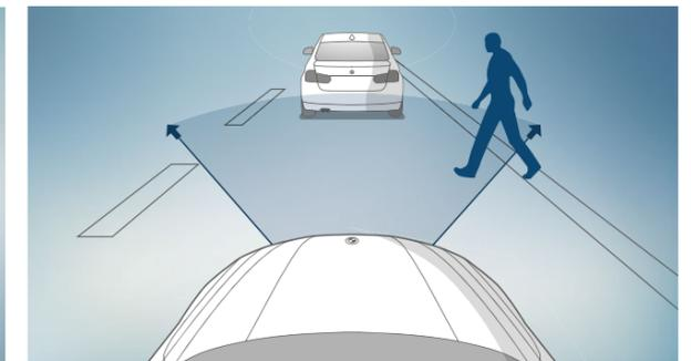
■ Während die **Auffahrwarnung mit City-Bremsfunktion** Fahrzeuge erkennt, reagiert die **Personenwarnung** auf Fußgänger. Zugleich werden die Bremsen für ein schnelleres Ansprechen vorkonditioniert. Wird eine Kollision unvermeidbar, leitet das System eine Vollbremsung ein.
