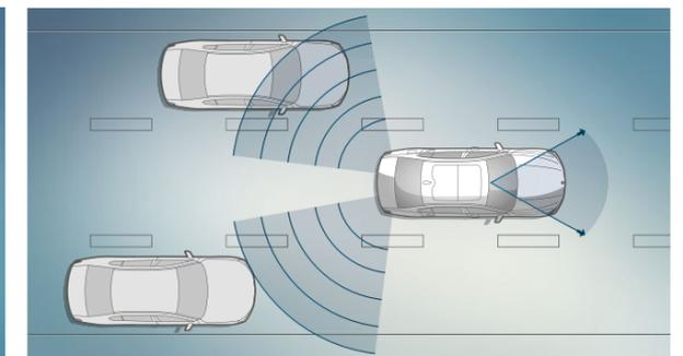
■ Die **Spurverlassenswarnung**<sup>2</sup> erkennt Spurmarkierungen und warnt den Fahrer ab ca. 70 km/h durch eine Vibration des Lenkrades vor ungewolltem Verlassen der Fahrspur. Nähern sich Fahrzeuge im toten Winkel, warnt die **Spurwechselwarnung**<sup>1</sup> per Lenkradvibration und blinkendem Warnsymbol am Außenspiegel.
