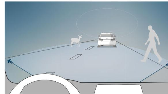
□ **BMW Night Vision** mit Personenerkennung macht Personen und größere Tiere bei Dunkelheit aus weiter Distanz per Wärmebild im Control Display erkennbar und leuchtet sie mit dem Dynamischen Markierungslicht des Hauptscheinwerfers gezielt an.
