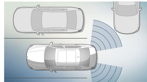
■ Die **Querverkehrswarnung hinten** und **Prävention Heckkollision** des Driving Assistant warnen vor Querverkehr bei schlecht einseharen Verkehrssituationen und erkennen drohende Heckkollisionen. Der nachfolgende Verkehr wird per Warnblinkanlage vor einer Kollision gewarnt.
