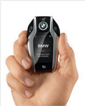
□ Der BMW Display Schlüssel zeigt diverse Statusdaten des Fahrzeugs und erlaubt die Bedienung ausgewählter Funktionen per integriertem Touch-Display.
