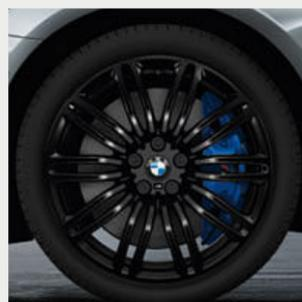
□ 19" M Leichtmetallräder Doppelspeiche 664 M Jet Black<sup>1</sup>, mit Notlaufeigenschaften und Mischbereifung, Radgröße vorn 8J x 19, Bereifung 245/40 R19, Radgröße hinten 9J x 19, Bereifung 275/35 R19.
