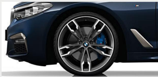
○ 20" M Leichtmetallräder Doppelspeiche 668 M Ceriumgrau matt glanzgedreht, mit Sportreifen und Mischbereifung, Radgröße vorn 8J x 20, Bereifung 245/35 R20, Radgröße hinten 9J x 20, Bereifung 275/30 R20.
