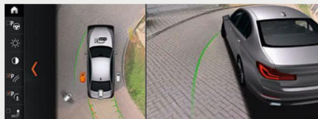
□ Das Ausstattungspaket Parking Assistant Plus erleichtert das Parken und Rangieren des Fahrzeugs. Es umfasst Surround View inkl. Top View, Remote 3D View, PDC sowie den Parkassistenten mit Längsführung, der das Fahrzeug vollautomatisch parallel oder quer zur Fahrbahn parkt. Dazu misst das System Parklücken beim Vorbeifahren mit niedrigem Tempo aus.
