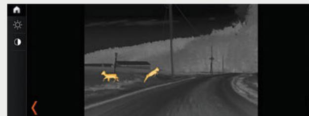
□ BMW Night Vision mit Personenerkennung macht Personen und größere Tiere bei Dunkelheit aus weiter Distanz per Wärmebild im Control Display erkennbar und leuchtet sie mit dem Dynamischen Markierungslicht des Hauptscheinwerfers gezielt an. Eine zusätzliche Warnfunktion wird beim Starten des Fahrzeugs unabhängig von der Bildanzeige automatisch aktiviert.
