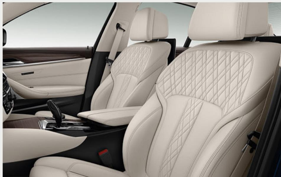
□ Die Komfortsitze für Fahrer und Beifahrer inkl. aktiver Kopfstützen sind vielfach elektrisch verstellbar. So lassen sich das obere Lehnensegment, die Lehnenbreite, die Oberschenkelauflege und die Kopfstützenhöhe individuell anpassen. Der Ausstattungsumfang umfasst zudem die Lordosenstütze und die Memory-Funktion für Fahrer und Beifahrer.
