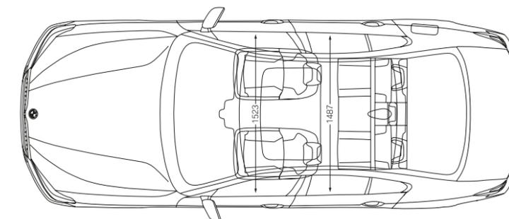
Alle Maßangaben der technischen Zeichnung in Millimeter. Höhe ohne Dachantenne beträgt 1466 mm. Angaben zu Fahrleistung, Verbrauch und CO<sub>2</sub>-Emission gelten für Fahrzeuge mit Seriengetriebe. Werte in [ ] gelten für Fahrzeuge mit Steptronic Getriebe.
