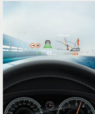
□ Das vollfarbige BMW Head-Up Display<sup>1</sup> blendet per optischer Projektion alle für die Fahrt relevanten Daten in das Sichtfeld des Fahrers ein.
