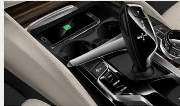
□ Die Telefonie mit Wireless Charging<sup>3</sup> umfasst eine Ladeschale mit drahtloser Ladefunktion und zusätzlichen USB-Anschlüssen. Eine Dachantennenanbindung sorgt für besseren Mobilfunkempfang. Per Bluetooth lassen sich zwei Mobiltelefone und ein Audioplayer zugleich verbinden. Dazu kommen Bluetooth Office sowie eine WLAN Hotspot Vorbereitung.
