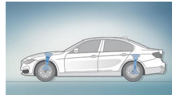
□ Das tiefergelegte<sup>1</sup> **Adaptive Fahrwerk** mit variabler Dämpfereinstellung bietet die Wahl zwischen komfortabler oder sportlicher Fahrwerksauslegung. Die Sicherheit wird durch die permanente Anpassung des Fahrwerks an die Fahrsituation erhöht.
