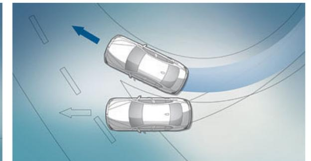
■ Die **Dynamische Stabilitäts Control (DSC)** erkennt Schleuderneigung und stabilisiert das Fahrzeug.
