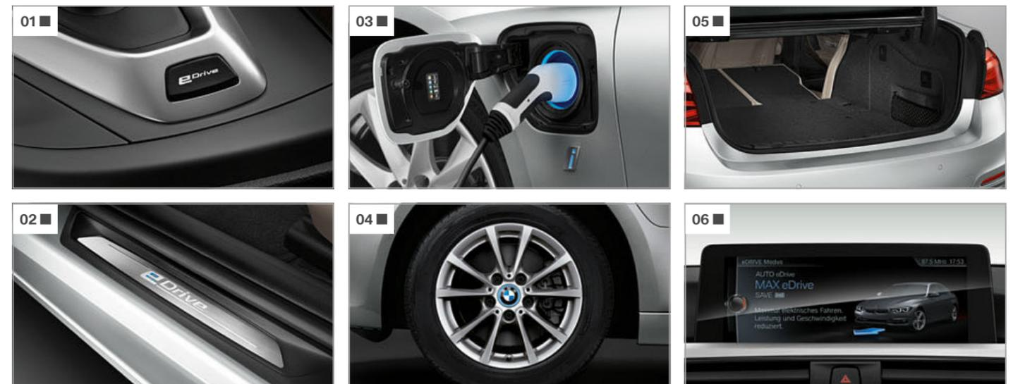
**[ 01 ]** Über die eDrive-Taste kann der Fahrer zwischen drei elektrischen Antriebsmodi wählen: AUTO eDrive (Standard), MAX eDrive oder SAVE BATTERY.
