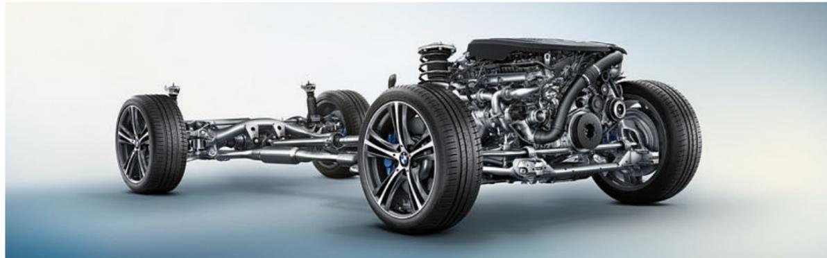
Eine ideale **Achslastverteilung von 50:50** ist einer der Garantien für hohe Spurstabilität, agiles Handling und präzises Lenkverhalten. Ein tiefer Schwerpunkt sowie ein langer Radstand mit kurzen Karosserieüberhängen optimieren die Bedingungen für diese positiven Fahreigenschaften.
