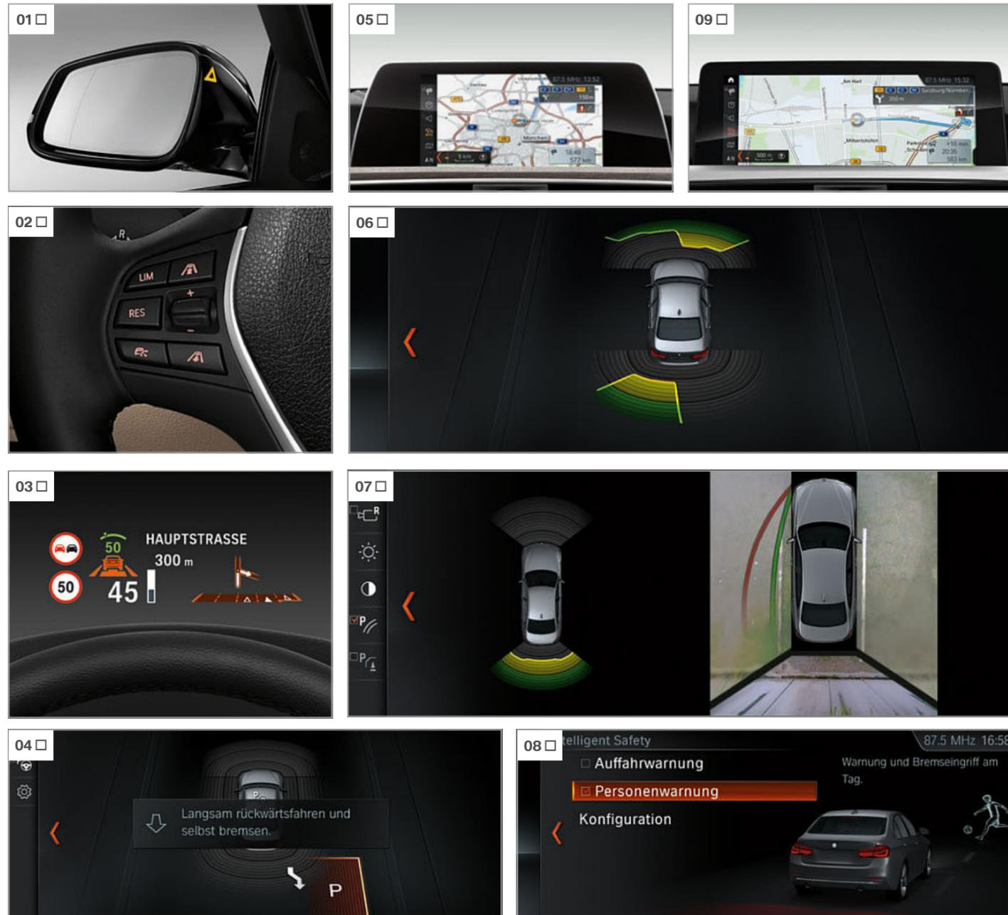
**[ 01 ]** Die Spurwechselwarnung warnt den Fahrer beim Spurwechsel optisch und per Lenkradvibration vor Fahrzeugen im toten Winkel bzw. auf der Nachbarspur.
