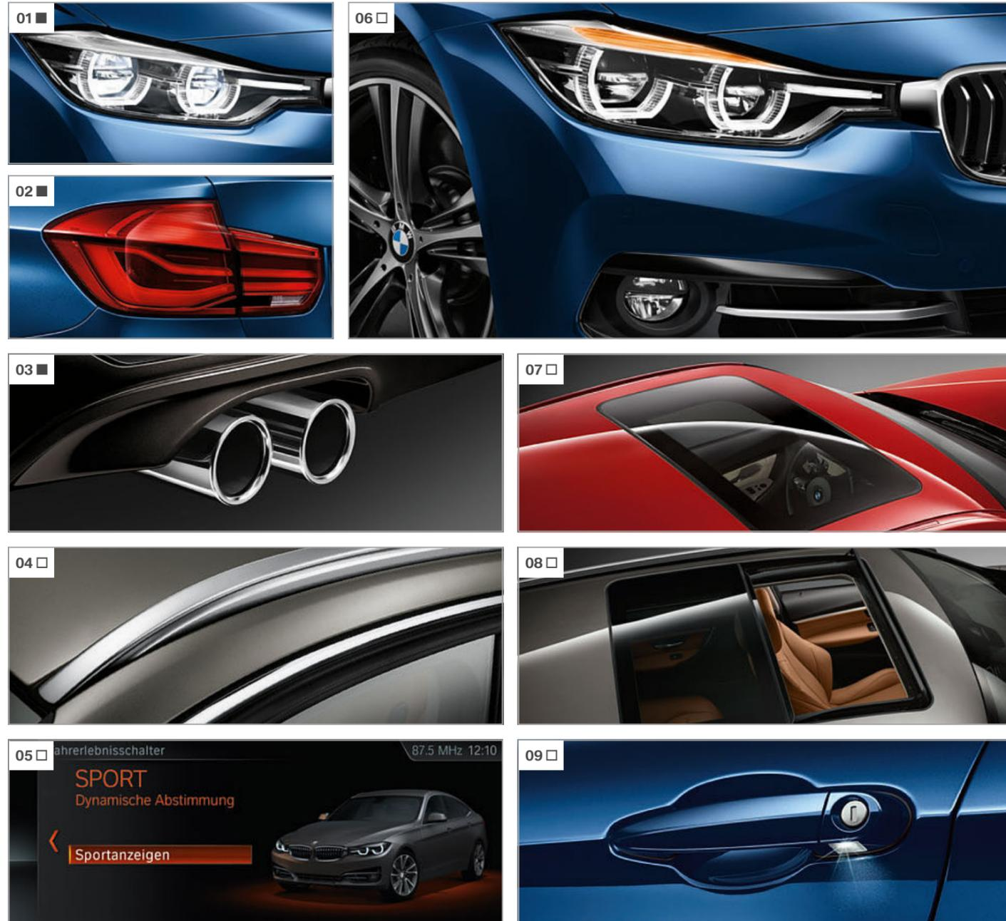
**[ 01 ]** Alle Funktionslichter der LED-Scheinwerfer sind mit LED-Technik ausgestattet. Sie strahlen ein besonders helles Licht aus und verbrauchen wenig Energie. Der Blinker ist oberhalb der Lichttuben platziert.
