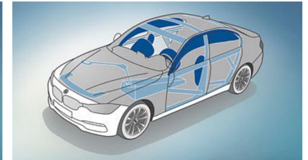
■ Die **Airbags für Fahrer und Beifahrer** sowie Kopf- und Seitenairbags bieten gezielten Schutz bei Unfällen. Die Fahrgastzelle sorgt für optimale passive Sicherheit im Falle eines Front-, Seiten- und Heckcrashes.
