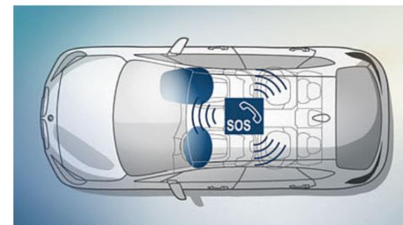
■ **Intelligenter Notruf** stellt bei Bedarf automatisch über das BMW Callcenter die Verbindung zur nächsten Rettungsleitstelle her – unabhängig von einem privaten Mobiltelefon. Neben der aktuellen Fahrzeugposition werden zusätzlich Daten über die Unfallschwere übermittelt. Der Intelligente Notruf lässt sich auch manuell auslösen.
