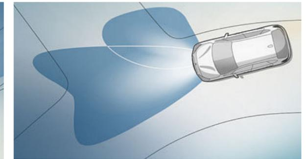
□ **LED-Scheinwerfer mit Abbiegelicht** bieten ein lichtstarkes und effizientes Bi-LED-Licht für Abblend- und Fernlicht. Das Abbiegelicht in LED-Technologie ermöglicht eine adaptive Lichtverteilung mit erhöhter Seitenausleuchtung im Stadtverkehr.
