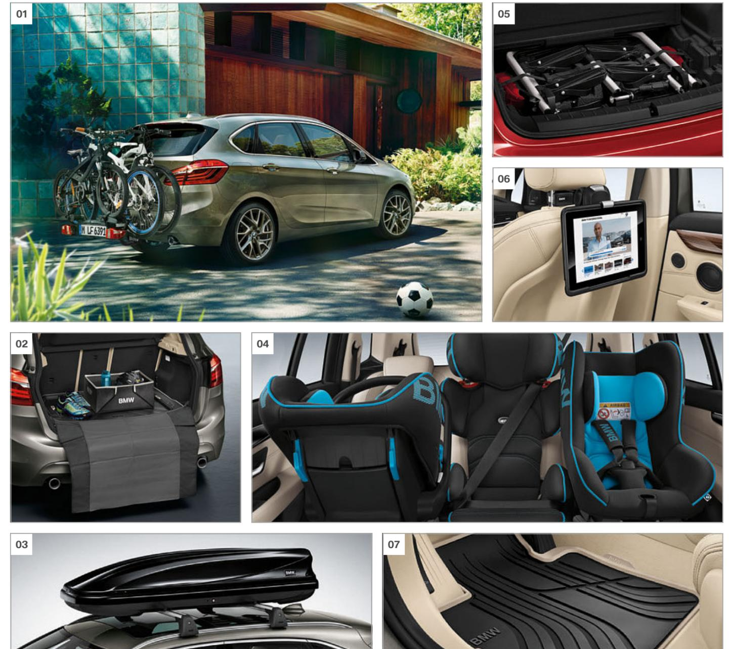
**[ 01 ]** E-Bike-Halterung für den Transport von bis zu drei Rädern (max. 60 kg), Erweiterungssatz für ein drittes Rad erhältlich. Sichere Montage auf der Anhängerkupplung. Abklappfunktion für einfachen Zugang zum Gepäckraum.
