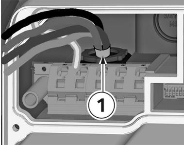
1. Führen Sie die Versorgungsleitung durch die Kabelverschraubung und ziehen Sie diese fest. Der Kabelmantel **1** muss im Anschlussbereich sichtbar sein.
