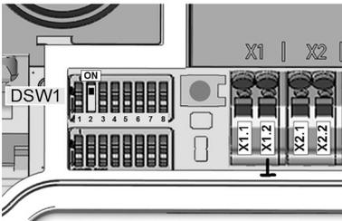
Die Verwendung der Hauslastüberwachungsfunktion mit RS485-Zählern muss mit einer DIP-Switch-Einstellung ausgewählt werden und ist erst nach einem Neustart der Wallbox wirksam. Wird bei aktivierter Modbus-Funktion kein Zähler **5** gefunden, wird eine Reduktion des Ladestroms auf 10 A vorgenommen.
