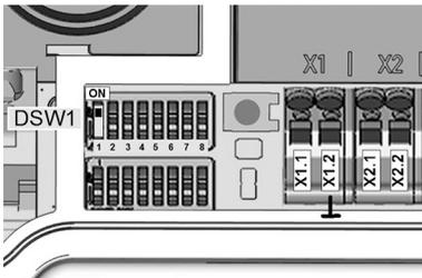
Die Verwendung des Freigabeeingangs muss mit einer DIP-Switch Einstellung aktiviert werden.
