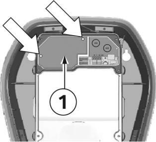
1. Lösen Sie die zwei Befestigungsschrauben der Klemmenabdeckung **1**.
