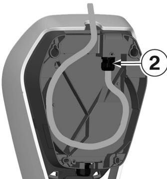
2. Verlegen Sie die Versorgungsleitung in einer Schlaufe zur Kabelverschraubung **2**. Beachten Sie die zulässigen Biegeradien des Kabels.
