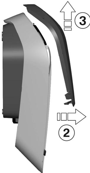
2. Schwenken Sie die Gehäuseabdeckung an der Unterseite ein Stück nach vorne **2**.
