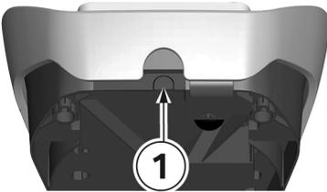
Die Anschlusskabel können von oben durch die Gehäuseöffnung im Außenrahmen eingeführt werden.
