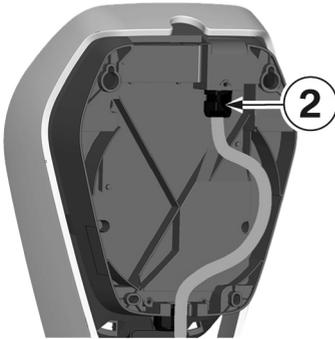
1. Verlegen Sie die Versorgungsleitung in einer Schlaufe zur Kabelverschraubung **2**. Beachten Sie die zulässigen Biegeradien des Kabels.
