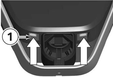
1. Drücken Sie an der Unterseite der Wallbox die zwei Verriegelungen **1** der Gehäuseabdeckung nach oben. Die Gehäuseabdeckung sollte dabei unten ein Stück herauspringen.
