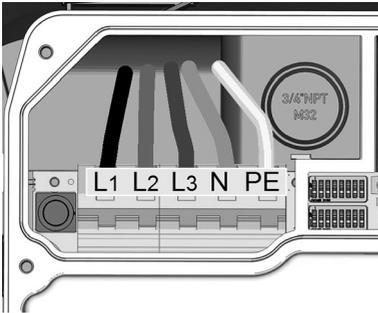
1. Kürzen Sie die Anschlussdrähte auf die passende Länge. Diese sollte möglichst kurz gehalten werden.
