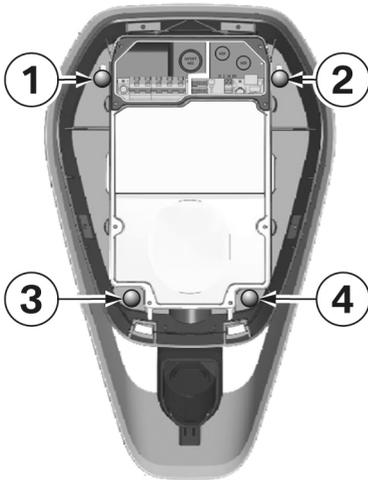
1. Hängen Sie nach der Kabeleinführung die Wallbox auf die zwei oberen Tellerkopfschrauben **1** und **2** ein.
