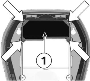
1. Lösen Sie die vier Schrauben, mit denen die Anschlussfeldabdeckung **1** montiert ist.
