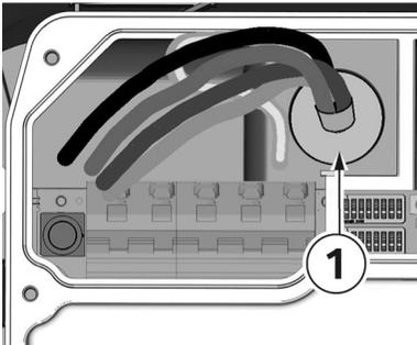
1. Die Versorgungsleitung muss, wie abgebildet, durch die Durchführung/ Doppelmembranstutzen **1** geführt werden.
