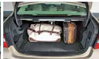
Ein Rückschritt: freiliegende Scharnierbügel im Kofferraum
